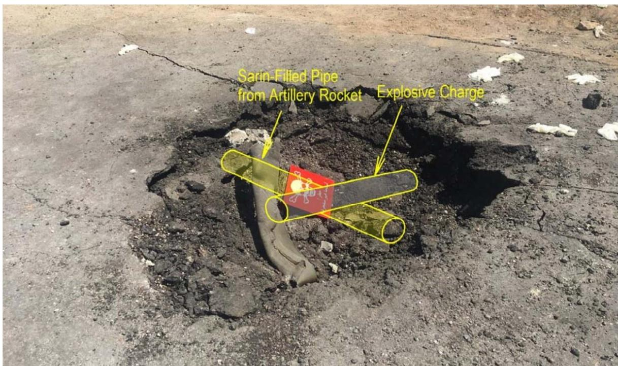
**Figure 4 :** Configuration possible d'un dispositif improvisé de dispersion de sarin qui utilise un explosif placé à l'extérieur et un tube scellé qui a été rempli de sarin, pouvant potentiellement contenir de 8 à 10 litres de sarin.
