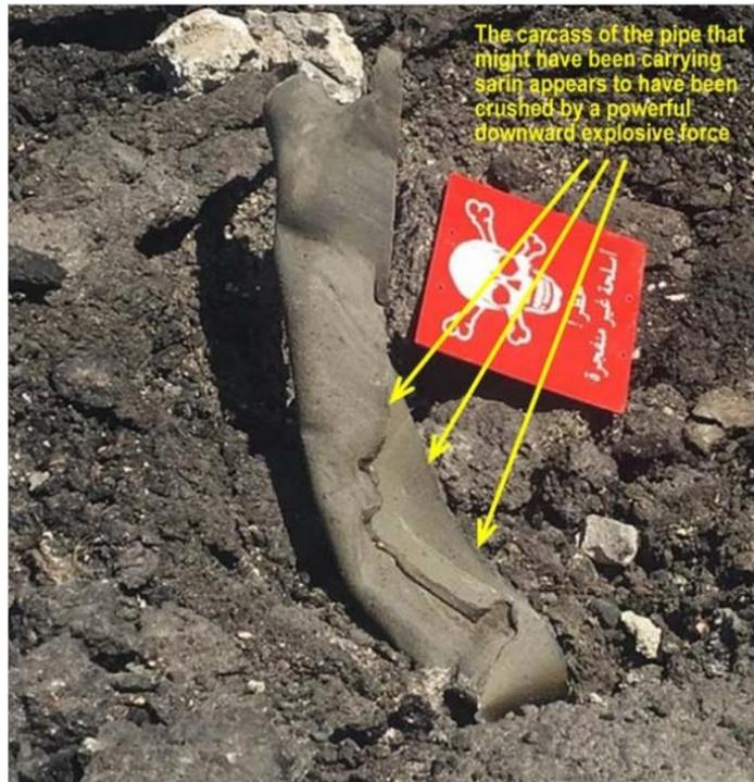
**Figure 3 :** Déformation du tube rempli de sarin et du cratère issu de l'action de la charge explosive placée au-dessus du tuyau rempli de sarin. Notez que le tube a été aplati de l'extérieur et a éclaté sur sa longueur et à l'extrémité en raison de l'action du sarin liquide incompressible contre les parois du tube. ["La carcasse du tube qui aurait pu contenir le sarin apparaît comme ayant été écrasé par une puissante force explosive vers le sol"]
